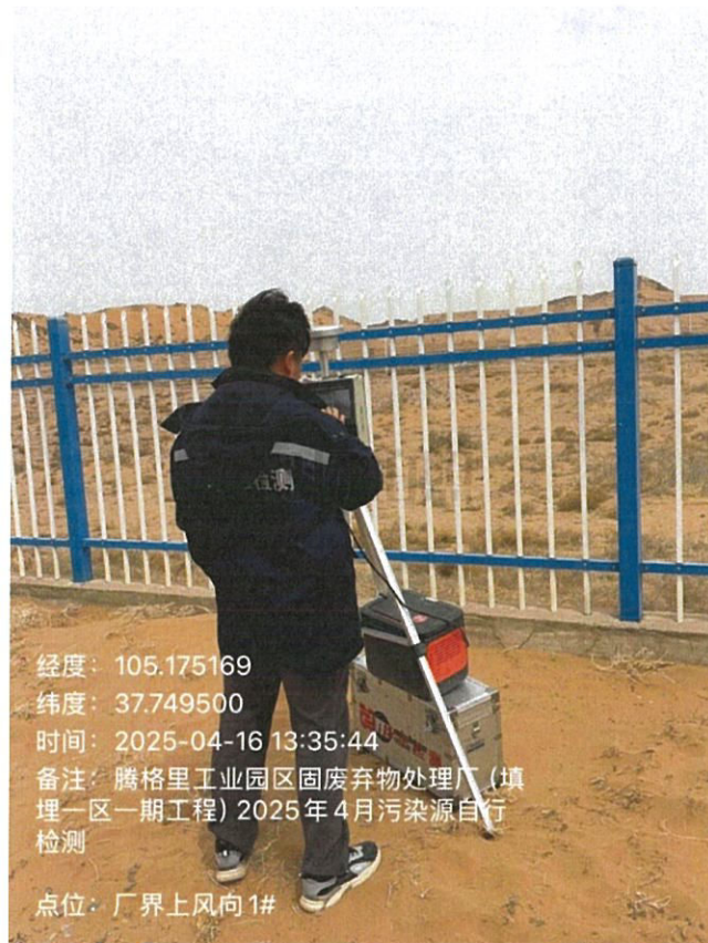
图 2 无组织排放废气现场采样
